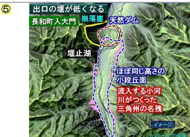
堰が低くなるメカニズムは狭隘な谷中でしばしば見ることができます。図の上部で崩落(黄色線)が発生し、崩落堆(茶色破線)が天然ダムとなって河川を堰き止め、堰止湖(青色破線)が形成され、やがて排水口の下刻作用により、堰止湖は水位低下、さらに消滅に至ったと思われます。
