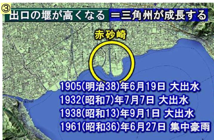
堰が成長する様子は、下諏訪町赤砂崎でみることができます。赤砂崎は、何回かの大雨のたびに流下した泥流が諏訪湖に突入することで、泥流の土砂が陸地の先まで運ばれ、三角州が成長してきました。
