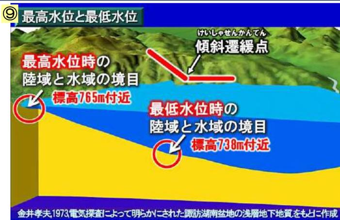
諏訪盆地下の支持基盤までの等深度線を見ると、標高765mと738m付近に傾斜遷緩点があります。傾斜遷緩点は、扇状地と三角州の境目、つまり陸域と水域の境目を表しており、約2万年前以降の諏訪湖の最低水位738m、最高水位765mに当たると考えられます。
